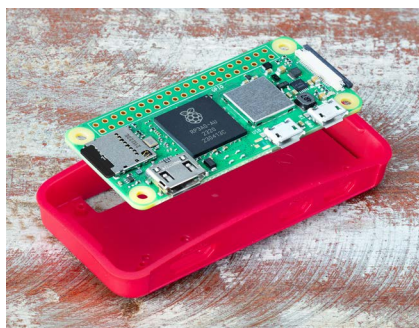
Figura 2-10 Colocar o Zero na caixa
