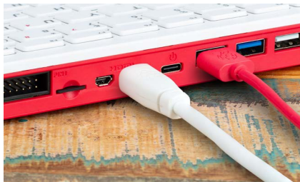
Figura 2-22 Conectar o cabo HDMI ao Raspberry Pi 400
