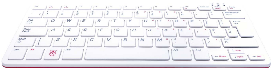
Figura 1-17 O Raspberry Pi 400 tem um teclado integrado
