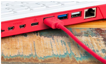
Figura 2-21 Conectar um cabo USB ao Raspberry Pi 400
