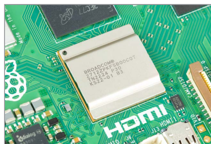
Figura 1-2 Sistema em um chip (SoC) do Raspberry Pi
