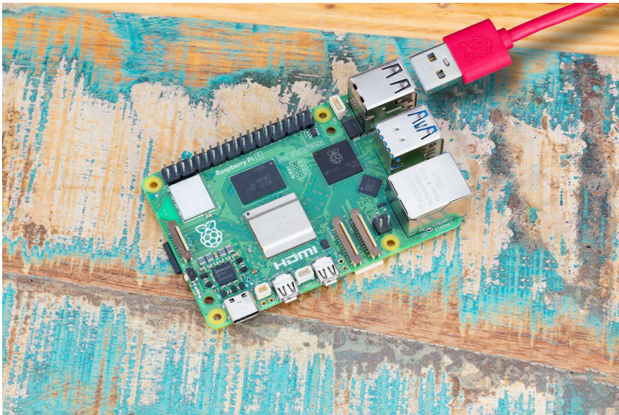
Figura 2-14 Conectar um cabo USB ao Raspberry Pi 5
