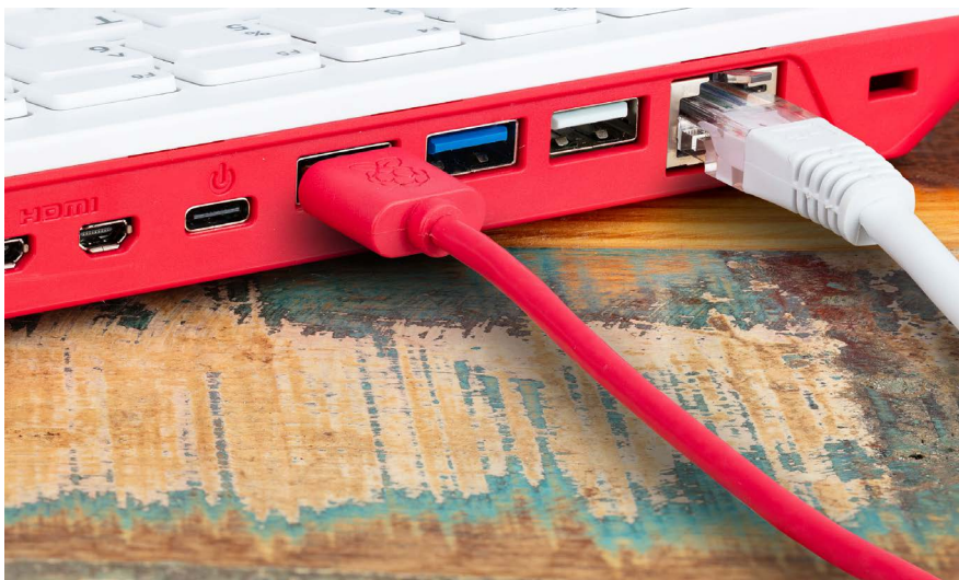
Figura 2-23 Conectar o Raspberry Pi 400 à Ethernet
