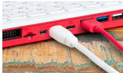
Abbildung 2-22 Anschließen des HDMI-Kabels an einen Raspberry Pi 400
