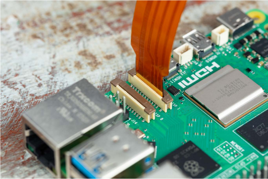
Abbildung 8-3 Flachbandkabel an den Kamera-/CSI-Anschluss des Raspberry Pi anschließen
