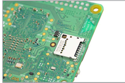
Abbildung 1-16 Der microSD-Karten-Anschluss
