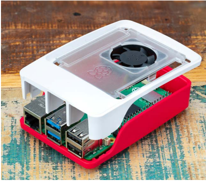
Abbildung 2-7 Anbringen der Lüfterbaugruppe und des Rahmens
