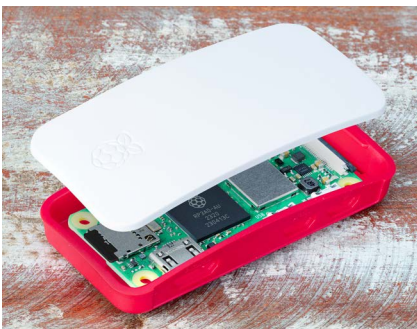
Abbildung 2-11 Anbringen des Deckels
