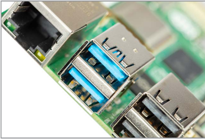
Abbildung 1-7 USB-Anschlüsse des Raspberry Pi
