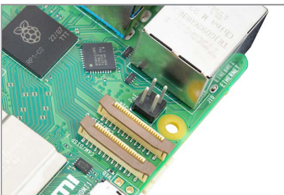
Abbildung 1-9 Der Power-over-Ethernet-Anschluss des Raspberry Pi
