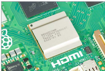
Abbildung 1-2 Das System-on-a-Chip (SoC) des Raspberry Pi
