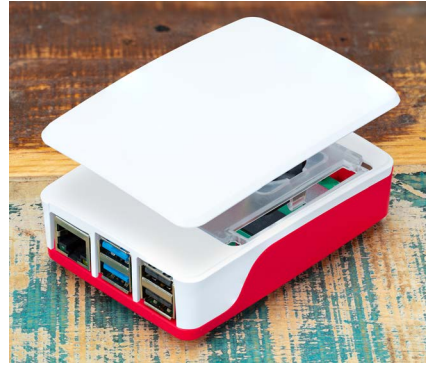
Abbildung 2-8 Aufsetzen des Deckels auf das Gehäuse
