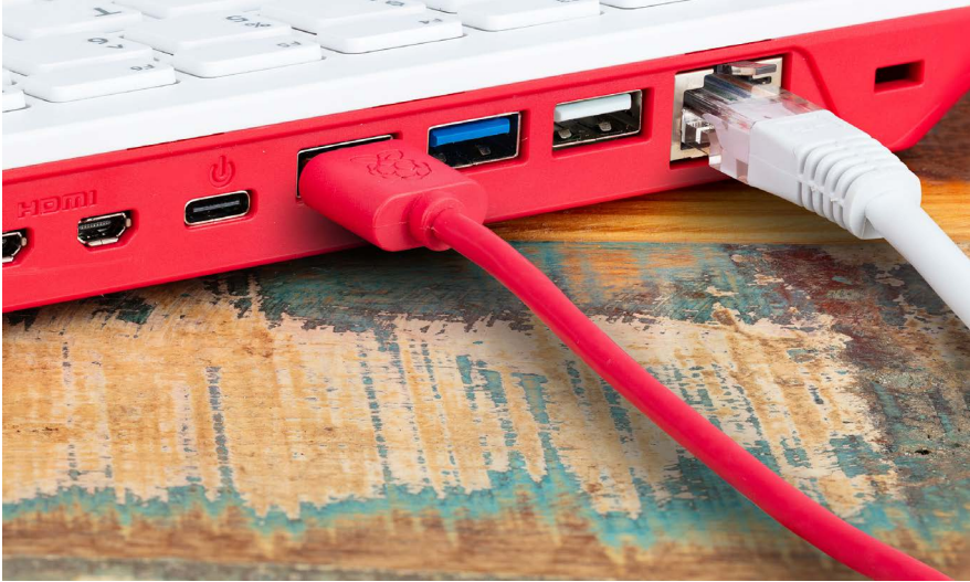
Abbildung 2-23 Verbinden des Raspberry Pi 400 mit dem Ethernet
